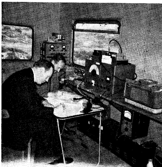
De 'shack' van PE1PL, achter de paraboloïde. Op de voorgrond OM Jansen, daarachter OM Jan Flint (PAoKT). Bovenop de 2 m achterzetontvanger van PE1PL staat de geheel coaxiaal uitgevoerde 70 cm convertor. Vlak naast PAoKT ziet u de op de coax.lijn geprikte AF139 voorversterker. (Foto: P. J. Jansen)
